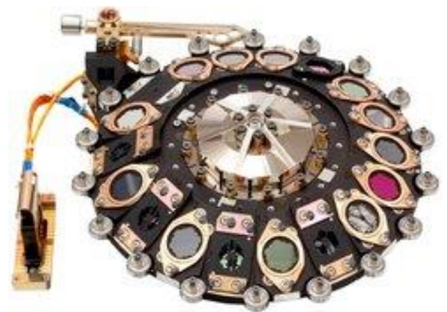
Con la excepción de los elementos ópticos, el MPIA ha planeado, diseñado, construido y probado la rueda de filtro. Los 18 elementos ópticos incluyen filtros para reducir el rango de longitud de onda, coronógrafos para cubrir objetos brillantes y un prisma. © IMP de Astronomía
